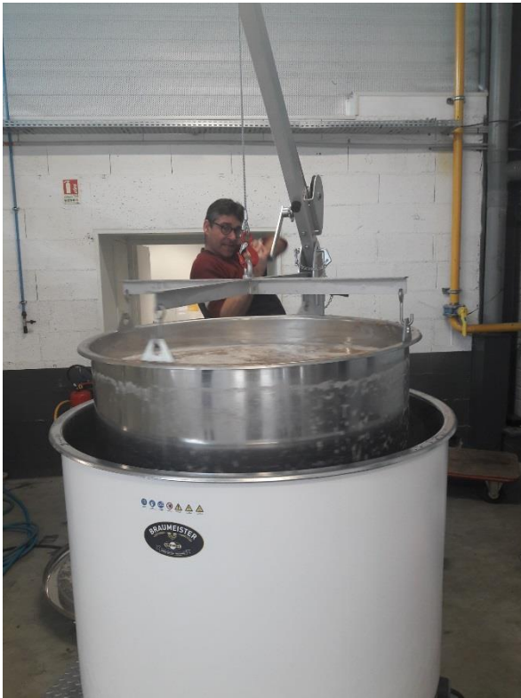
Sortie des dreches
